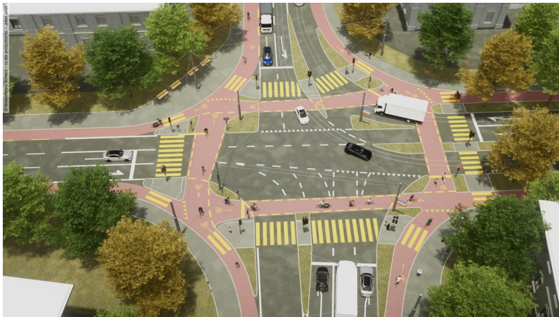
Illustration d'un carrefour adapté aux cyclistes. Source: Conférence Vélo Suisse
